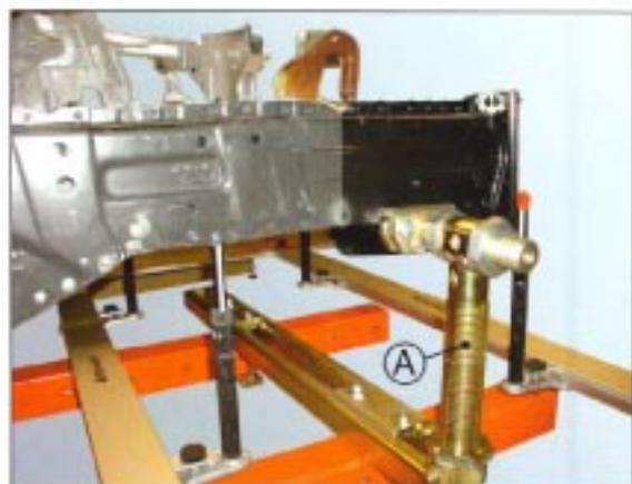
С помощью многофункционального опорного/двигового комплекта легко спозиционировать заменяемую часть лонжерона перед соединительной сваркой. Опорный винт А можно использовать при выправке для фиксирования неповреждённой области кузова.
