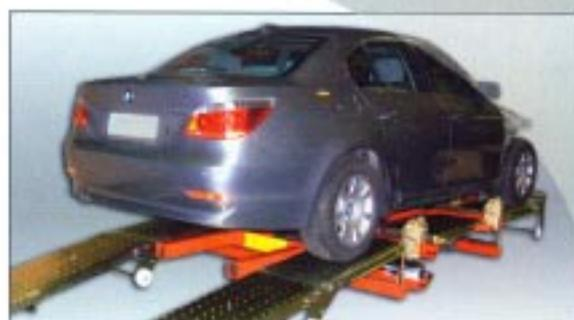
Стадии закрепления автомобиля сведены к минимуму, благодаря конструкции станда, позволяющей держать пороговые крепления на станде, всегда готовыми к работе.
